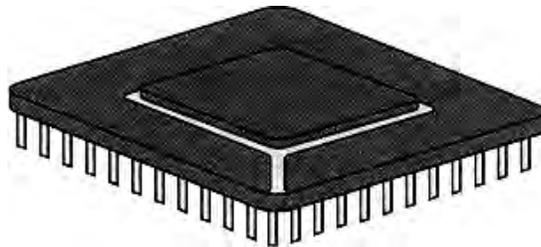
Fig. 2.12 Pin grid array [5].
