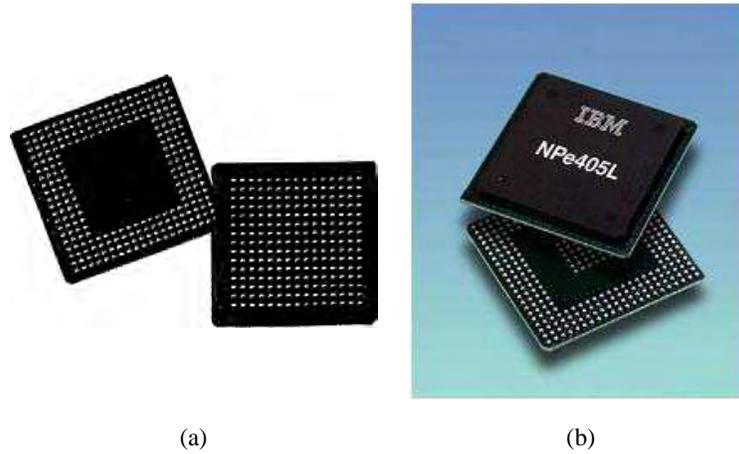
Fig. 2.15 Ball grid array [5].
